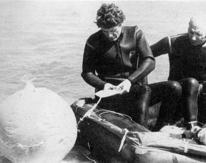
Essai d'un solarstyle : de l'eau douce est fabriquée à partir de l'eau de mer.
